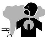
1.b. Utilizzare il motore in aree ben areate oppure predisporre un sistema di aspirazione dei gas di scarico.
