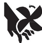
1.e. In alcuni casi potrebbe essere necessario rimuovere le protezioni di sicurezza per eseguire la manutenzione prescritta. Rimuovere le protezioni soltanto se necessario e rimontarle al termine dell'intervento di manutenzione per il quale è necessario rimuoverle. Prestare sempre la massima attenzione quando si opera in prossimità di organi in movimento.
