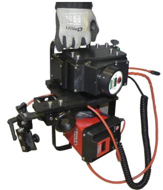
Posizionare il carrello sul binario di guida e bloccare i rulli di guida utilizzando la leva rossa.
