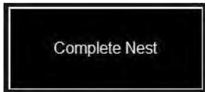
Si la anidación no necesita ninguna edición o se trata de una única pieza, puede elegir en la barra de herramientas de la derecha COMPLETE NEST (finalizar la anidación). De este modo se abrirá el cuadro de diálogo CREATE JOB (crear un trabajo). Indique el lugar donde desea guardar el trabajo y compruebe el amperaje del corte. A continuación, pulse OK.
