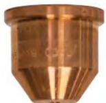
**La boquilla** es el consumible que se reemplaza con más frecuencia. Una de las señales de que se debe reemplazar la boquilla es la acumulación excesiva de escoria y el ángulo de bisel que aparece en los cortes. En la propia boquilla, constatará que un orificio más grande o un agujero de forma irregular serán signos de desgaste excesivo.
