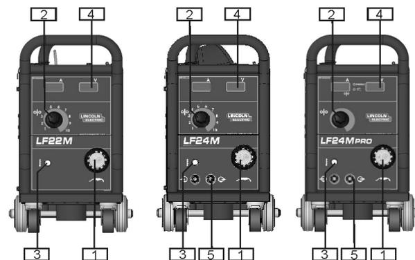
1. Евро (EURO) разъем горелки: Служит для подключения горелки.
