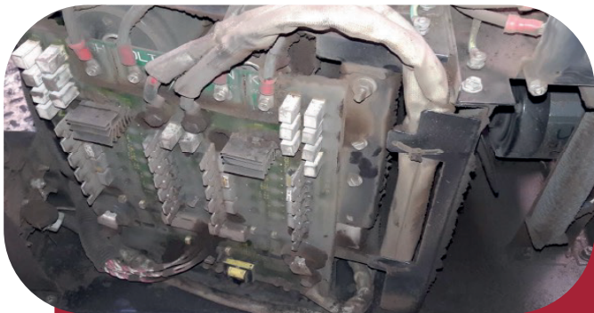
Se aplica aire a presión después del aspirado para desincrustar el posible polvo que aún quede.
