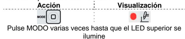
Cuando el botón de modo está en la posición Lift TIG, las funciones de soldadura por electrodo convencional se desactivan y la máquina está preparada para la soldadura Lift TIG. Lift TIG es un método para iniciar una soldadura TIG; primero, se apoya el electrodo de la antorcha TIG contra la pieza para crear un cortocircuito con una corriente de baja magnitud. Luego, se separa al electrodo de la pieza para crear el arco TIG.
