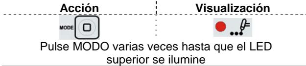
Este modo de soldadura se utiliza principalmente para realizar soldaduras provisionales o sobre materiales finos. El arco arranca con alta frecuencia y la corriente de soldadura se establece inmediatamente sin pendientes ascendente y descendente. El tiempo de soldadura se puede controlar mediante el gatillo o ajustando el tiempo de punto.
