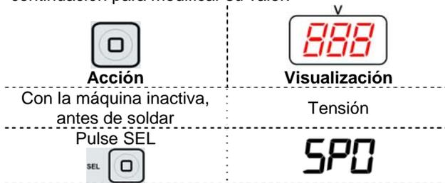
En esta etapa el tiempo de punto se debe ajustar girando el mando de ajuste de la corriente de salida. Si el tiempo de punto se ajusta en "0", la función de tiempo fijo se desactivará y el control del tiempo pasará a depender del gatillo de la antorcha TIG.
