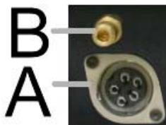
conectar la manguera al frente de ésta. A continuación, conecte una manguera entre el conector de gas en la parte posterior de la máquina y el regulador de gas instalado en el cilindro del gas empleado. Los ajustes necesarios están incluidos en el package. Conecte el cable del gatillo de la antorcha al conector (A) ubicado en el frente de la máquina.
