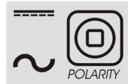
Über dieses Symbol wird die Polarität des verwendeten Verfahrens geregelt: DC+, AC Elektrode, DC- & AC WIG-Verfahren.
