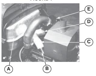
A. FUEL TANK B. HEAT COLLECTOR SHIELD
