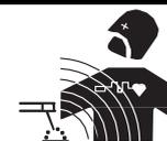
2.a. A corrente elétrica em passagem por qualquer condutor cria locais com campos eletromagnéticos (Electric and Magnetic Fields, sigla em inglês - EMF). A corrente de soldadura cria campos eletromagnéticos em torno dos cabos e equipamento de soldadura
