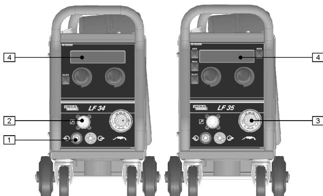
1. Hurtigkobling vann: For tilkobling av vannkjølt sveisepistol.
