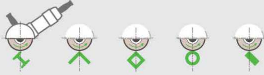
Çeşitli metal profillerin doğru biçimde kesilmesi
