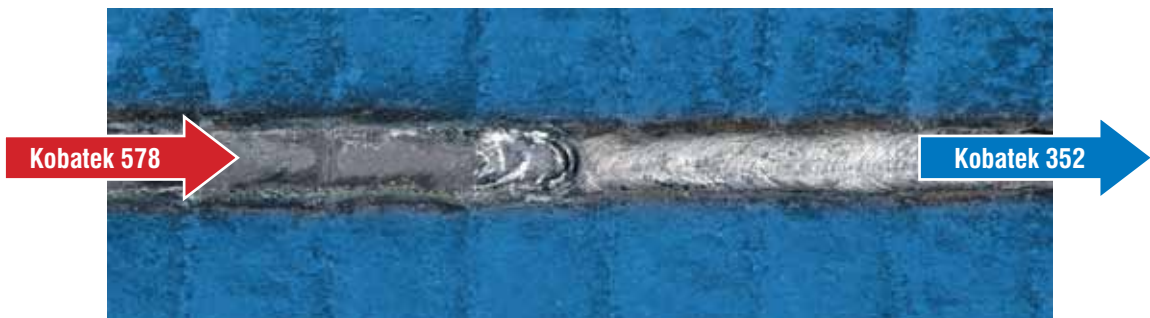
Kobatek® 352 ile kaynaklı birleştirme üzerine Kobatek® 578 ile sertdolgu uygulaması
