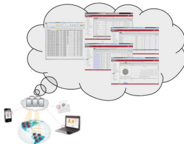
Durch die Verwendung von LACI mit der Power Wave® Manager-Software sind Sie in der Lage den Status jedes Gerätes in Ihrem Schweißsystem zu überprüfen (Software und Hardware-Version, Protokolle und Fehler); Sie können die Drahtvorschubparameter überprüfen und leicht einstellen (Einstellungen und Diagnose) des Weiteren können Sie die Namen Ihrer Speichereinstellungen anpassen.
