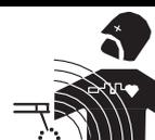
2.a. Elektrischer Strom, der durch die Leiter fließt, verursacht lokale elektrische und magnetische Felder (EMF). Schweißstrom erzeugt EMF-Felder rund um die Schweißkabel und Schweißgeräte.
