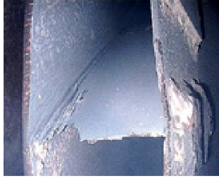
Koruma İşlemi Uygulanmamış Fan Kanadı — 2 ve/veya 4 Ay Çalıştıktan Sonra —
