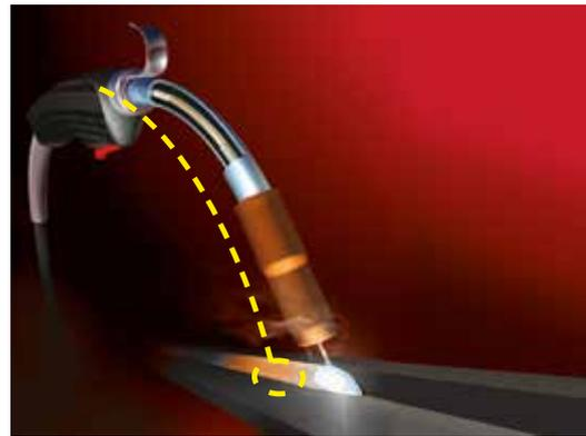
Schlechte Werte bei Aufsprung und Drall können Unterschiede bei der Lichtbogenform und im Einbrandprofil verursachen.
