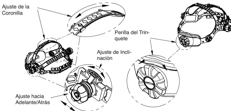
**AJUSTE AL TAMAÑO DE LA CABEZA:** La **TENSIÓN DEL CASCO** se ajusta oprimiendo la perilla del trinquete y girando para ajustar al tamaño de cabeza deseado. Esta perilla se localiza en la parte posterior de la careta. El **AJUSTE DE LA CORONILLA DEL CASCO** se logra ajustando la cinta hasta estar cómodo e introduciendo los pines en los orificios para asegurar.
