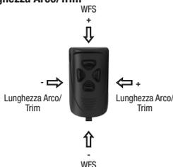
I pulsanti destro e sinistro regolano la lunghezza arco o il trim (tensione d'arco) in base alla modalità di saldatura.
