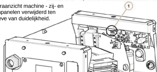
Afbeelding #4: Locatie dipschakelaar op gebruikersinterface-PCB.
