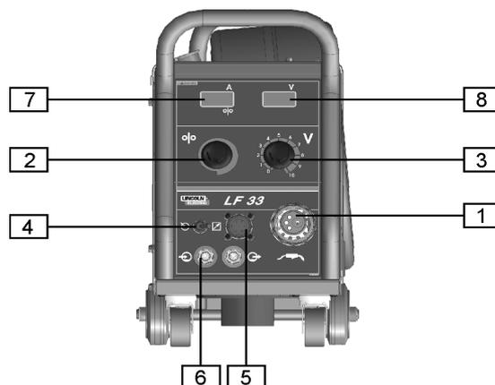
1. **EURO-Anschluss:** Zum Anschluss des Brenners.
