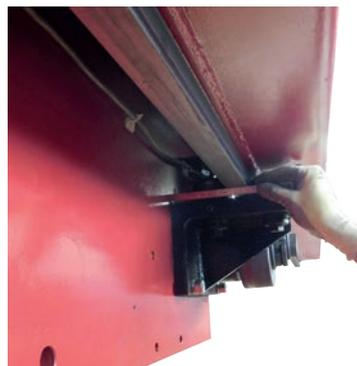
Compruebe que el brazo esté nivelado usando un nivel colocado en el raíl del brazo.
