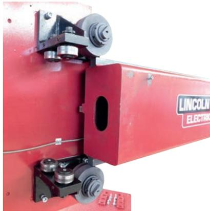
Instale el tope mecánico con 2 tornillos M10 X 40 CHC e Instale los 2 topes finales de recorrido eléctrico con 2 tornillos M 5 X 30 CHC
