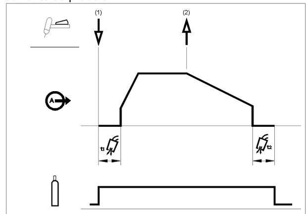
1. Maintenir enfoncé la gâchette de la torche TIG pour démarrer la séquence. La machine ouvre le robinet de gaz pour activer l'écoulement du gaz de protection. Après la durée de pré-gaz, pour purger l'air du tuyau de la torche, la sortie de la machine est activée. À ce stade, l'arc est démarré selon le mode de soudage sélectionné. Après le démarrage de l'arc, le courant de sortie augmente selon un taux contrôlé, ou une durée de pente montante, jusqu'à atteindre le courant de soudage.
