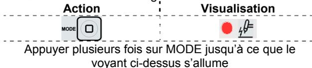
Lorsque le bouton-poussoir du mode se trouve en position TIG HF, les fonctions de soudage à l'électrode enrobée sont désactivées et la machine est prête pour le soudage TIG HF. Durant le mode TIG HF, l'arc TIG est démarré par HF sans appuyer l'électrode sur l'ouvrage. Le HF utilisé pour démarrer l'arc TIG reste actif pendant 3 secondes; si l'arc n'est pas démarré durant ce délai, la séquence de déclenchement doit être redémarrée.
