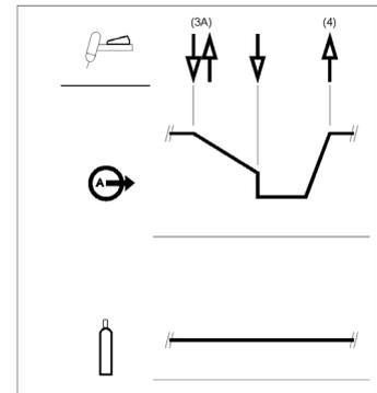
Lorsque la gâchette de la torche TIG est relâchée, la sortie augmente à nouveau jusqu'au courant de soudage, comme à l'étape 4, pour continuer le soudage. Lorsque la partie principale de la soudure est terminée, passer à l'étape 3.
