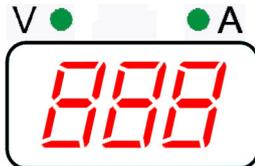
Si la LED A est allumée, l'afficheur indique le courant (A) souhaité avant soudage et le courant de soudage réel pendant le soudage. Si la LED V est allumée, l'afficheur indique la tension (V) aux câbles de sortie. Pour commuter entre la visualisation Courant et la visualisation Tension :
