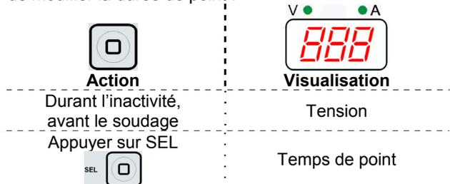
À ce stade, la durée de point peut être ajustée en tournant le bouton du courant de sortie. Le réglage de la durée de point à 0 désactivera la fonction de durée fixe et la durée de soudage sera liée à la gâchette de la torche TIG.
