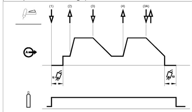
3. Maintenir enfoncée la gâchette de la torche TIG. La machine diminuera alors le courant de sortie selon un taux contrôlé, ou une durée de pente descendante, jusqu'à atteindre le courant de creux.
