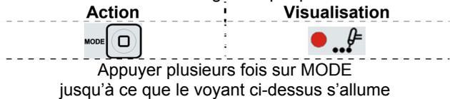
Ce mode de soudage est spécialement conçu pour appliquer un point de soudure ou pour souder les matériaux fins. Il emploie un départ HF et fournit immédiatement le courant défini sans aucune pente montante ou descendante. La durée de soudage peut être liée à la gâchette ou définie avec le contrôle de durée de point.
