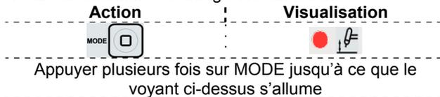
Lorsque le sélecteur de mode de soudage est sur la position Lift Tig, les fonctions pour le soudage à l'électrode enrobée sont inactives et la machine est prête pour le soudage TIG au touché. Le TIG au touché est une façon de démarrer le soudage TIG. Avec l'électrode en contact sur la pièce, l'appui sur la gâchette de torche génère un faible courant de court circuit et lorsque l'électrode est relevée de la pièce, l'arc TIG démarre.
