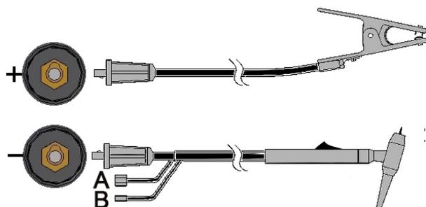
Raccorder le câble de la torche à la borne (-) de la machine et la pince de masse à la borne (+). Insérer le connecteur avec la clavette alignée avec la rainure et tourner d'environ ¼ de tour dans le sens des aiguilles
