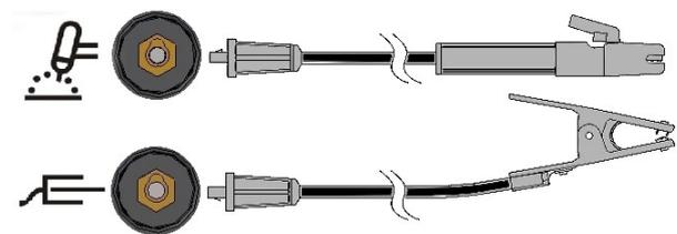
Brancher le câble de l'électrode à la borne de torche et le câble de la pince de masse à la borne de masse. Insérer la fiche en orientant le téton vers le haut en face de l'encoche et la faire tourner d'un quart de tour environ dans le sens horaire. Ne pas trop serrer.
