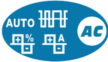
Ces icônes permettent à l'opérateur de personnaliser le mode de fonctionnement de l'arc en soudage TIG en courant alternatif.
