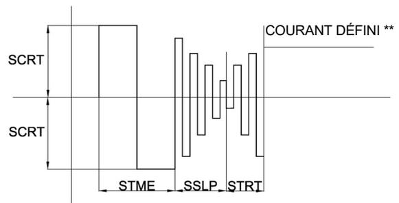
La séquence de démarrage change également si la commande au pied est présente : en fait, la prise en compte du niveau STRT n'est pas réglable ; le niveau à la fin de la pente SSLP est celui défini par la commande au pied ou le niveau PCRT.
