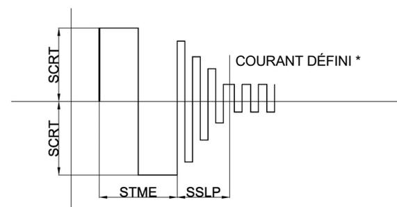
REMARQUE : les paramètres mémorisés assurent l'amorçage de l'arc lorsque l'utilisateur a correctement sélectionné le diamètre et la couleur de l'électrode.
