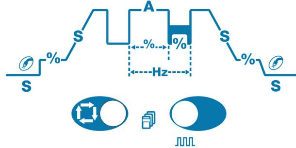
Le séquenceur permet la personnalisation de l'opération de soudage TIG en courant continu et alternatif. Chaque appui sur la touche "SEL" permet de passer à l'étape suivante dans le graphique du procédé.
