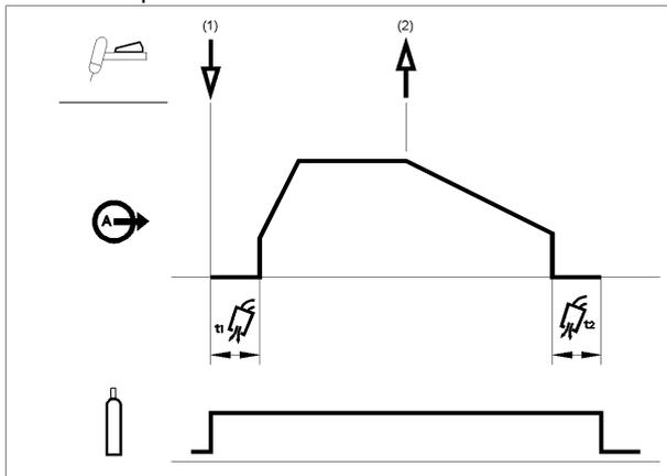
1. Maintenir la gâchette de la torche TIG enfoncée pour démarrer la séquence. Le robinet de gaz s'ouvre pour activer l'écoulement du gaz de protection. Après la durée de pré-gaz, pour purger l'air du tuyau de la torche, la sortie de l'appareil est activée. À ce stade, l'arc est démarré selon le mode de soudage sélectionné.
