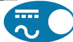
Cette icône sert au réglage de la polarité du procédé en cours d'utilisation : électrode enrobée CC+ et CA, TIG CC- et CA.
