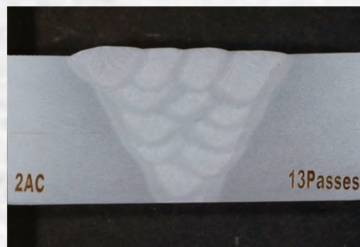
双丝埋弧焊 AC (板厚:40mm)
