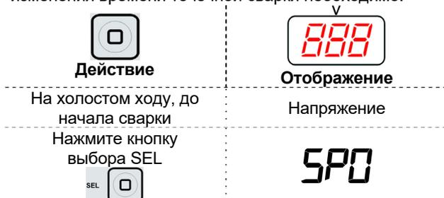
В этом случае время точечной сварки можно регулировать вращением ручки регулировки сварочного тока. При установке значения времени точечной сварки на 0 отключается функция фиксированного времени, и время сварки будет привязано к функциям курка TIG-горелки.
