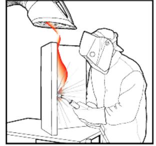
**USE SUFICIENTE VENTILACIÓN** o escape en el arco, o ambos, para mantener los humos y gases lejos de su zona de respiración y el área general.
