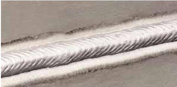
La fréquence des impulsions est ajustable. Un changement de la modulation de la fréquence (ou contrôle d'arc) de la forme d'onde changera l'espace entre les ondulations. On peut obtenir des vitesses de mouvements plus grandes en employant des valeurs plus élevées de modulation de fréquence.
