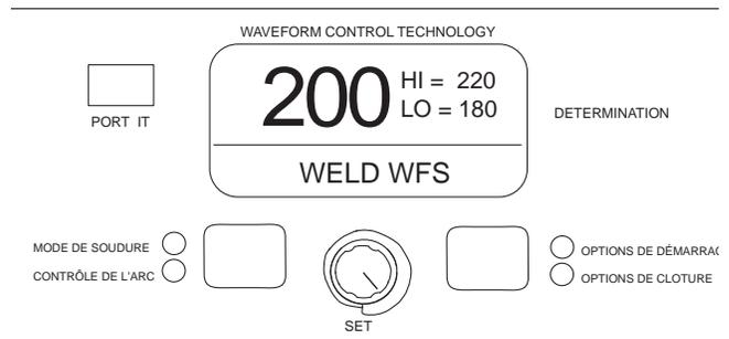
L'exemple ci-dessus montre un mode de fil, des modes de soudure de courant permanent afficheraient « Weld Amps » (Ampères de Soudure) au lieu de « Weld WFS » (Vitesses d'entraînement de fil pour soudure)
