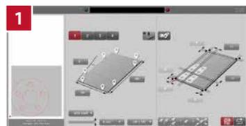
Programme de sélection du matériau, de l'épaisseur et du format de la tôle
