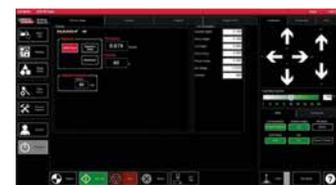
Console séparée avec écran multi-tactile 20" et commande numérique VMD (CNC).
