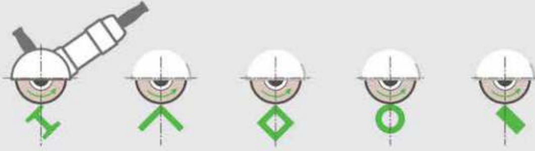
Çeşitli metal profillerin doğru biçimde kesilmesi
