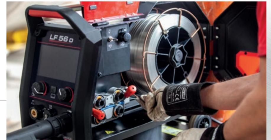
**Acceso completo para la instalación de la bobina de hilo**
