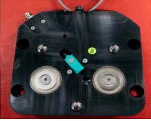
Mover a máquina até à posição de referência e desprender o suporte da tocha puxando a tocha pela parte inferior, para a esquerda ou para a direita.
