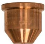
**A tubeira** é o consumível que se substitui com mais frequência. Um dos sinais que indica que a tubeira deve ser substituída é a acumulação excessiva de escórias e o ângulo do biselado presentes nos cortes. Na própria tubeira, se o orifício se alarga ou se torna irregular são sinais de desgaste excessivo.
