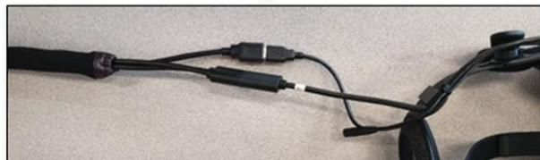
13. Saque el enganche del casco y la abrazadera USB de la bolsa del paquete de documentos. Guarde los manuales del HMD como referencia.
