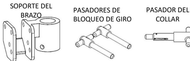
18. Instale el soporte del brazo colocándolo sobre el poste y deslizándolo hasta justo por encima de la altura deseada. Inserte parcialmente el pasador del collar en el orificio correspondiente. Mueva simultáneamente el soporte del brazo hacia abajo mientras inserta el pasador hasta que el soporte del brazo descansa sobre el pasador del collar y la punta del pasador se inserte en el soporte del brazo a través del orificio. Consulte la **Figura 20**.
