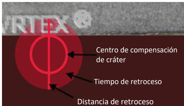
Cuando el dispositivo de soldadura esté cerca de la posición inicial, aparecerá un círculo. El color de la señal de círculo indica la distancia desde el centro del cráter hasta la posición inicial. El rojo está fuera de los límites de control y produciría un rectángulo de puntuación rojo en el gráfico de LASER. Un círculo verde se considera una posición de inicio aceptable.
