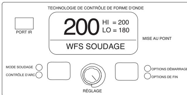
L'exemple précédent illustre un mode fil ; les modes de soudage à courant constant afficheraient « Amps de Soudage » plutôt que « WFS de Soudage ».
