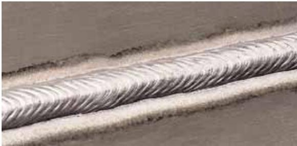
La fréquence des impulsions est ajustable. Le changement de la modulation de fréquence (ou du contrôle d'arc) de la forme d'onde modifie l'espacement des vagues de solidification. On peut obtenir des vitesses de déplacement plus rapides en utilisant des valeurs de modulation de fréquence plus élevées.
