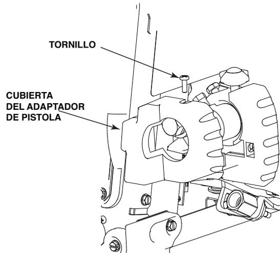
3. Con una llave de 3/4", remueva el perno que fija el cable del electrodo al adaptador de pistola
