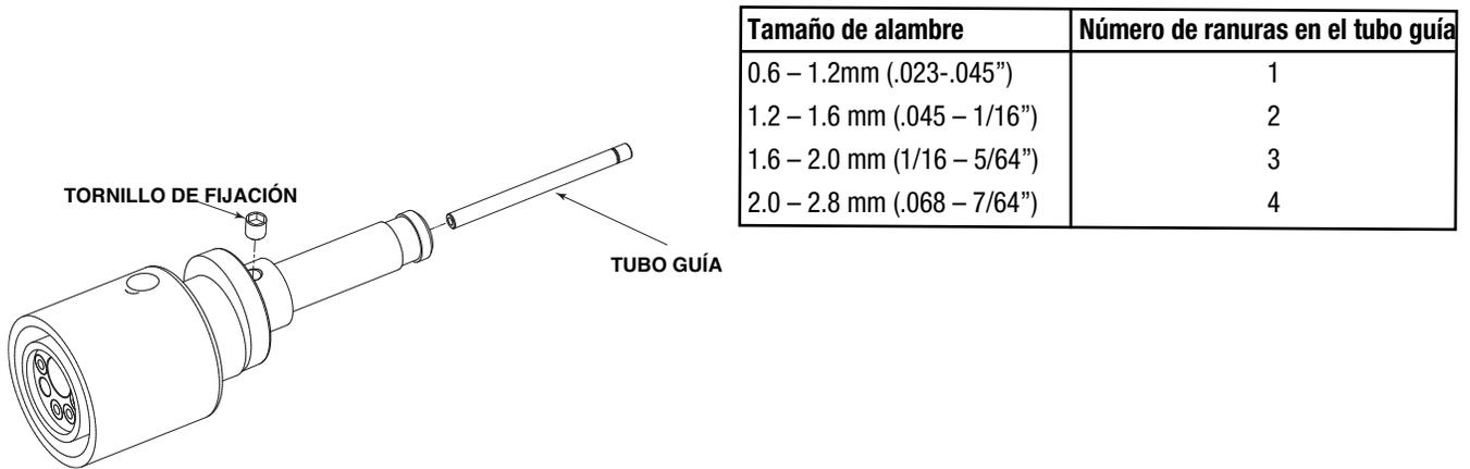
9. Deslice el adaptador de pistola Oxo o FastMate en el mecanismo de alimentación y asegure con el tornillo mariposa.
