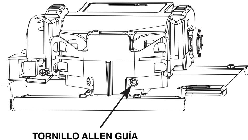
3. Gire el mecanismo de alimentación a la posición deseada y apriete el tornillo.
