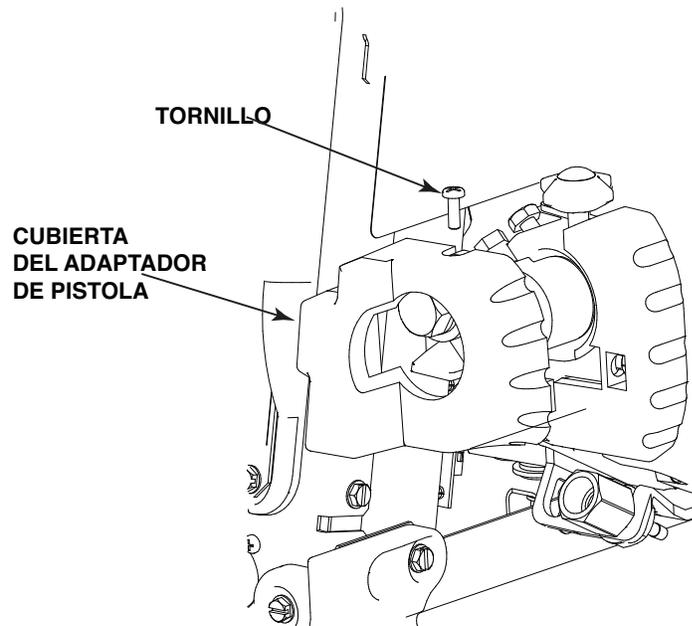
3. Con una llave de 3/4", remueva el perno que fija el cable del electrodo en el adaptador de pistola.
