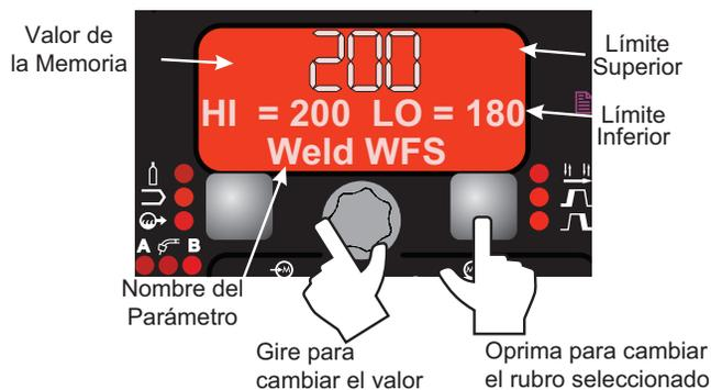
El menú de Configuración de Límites muestra una lista de todos los parámetros disponibles para el modo de soldadura almacenado en la memoria elegida. Por ejemplo, si los límites se están configurando para un modo de electrodo revestido (SMAW), no aparecerán parámetros como WFS de Avance Inicial y Postflujo.
