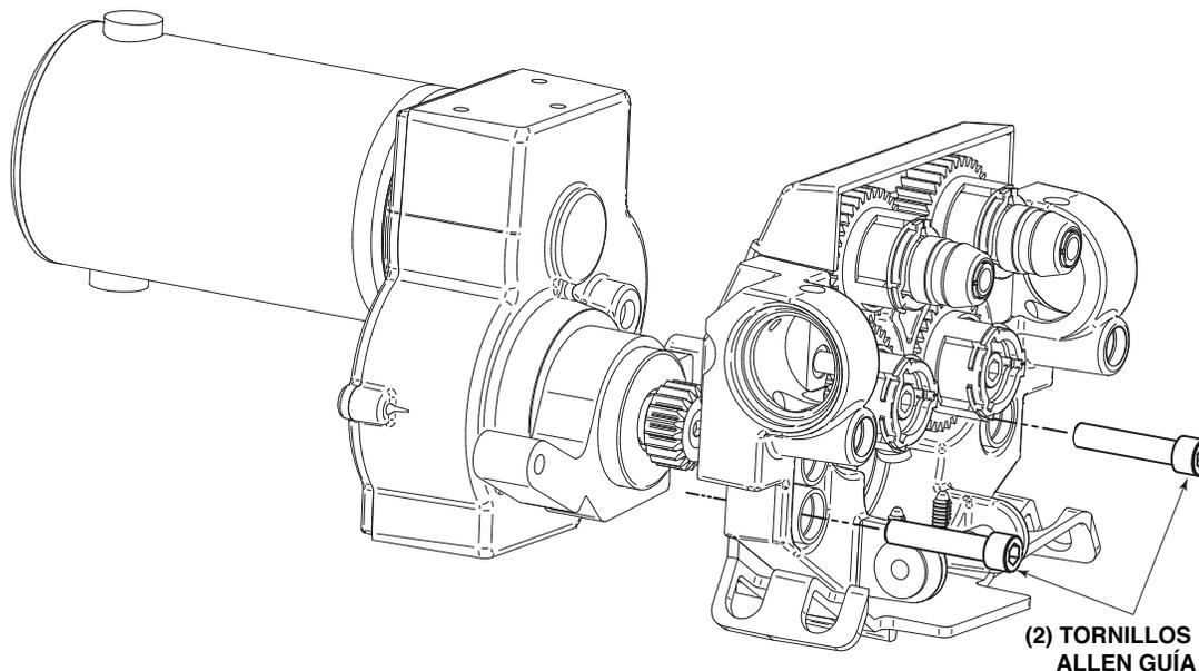
4. Remueva el tornillo que retiene al engranaje de piñón utilizando un desatornillador Phillips. Retire el engranaje de piñón.
