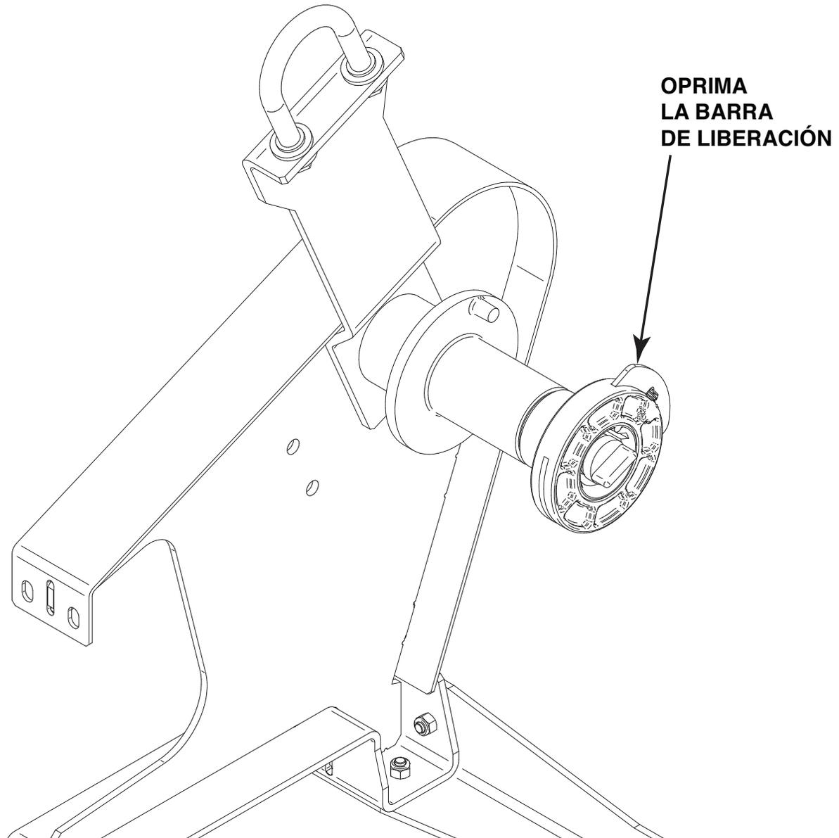
3. Coloque el adaptador del eje sobre el mismo, alineando el pin de freno del eje con uno de los orificios en el lado posterior del carrete. Una marca del indicador en el extremo del eje muestra la orientación del pin de sujeción del freno. Asegúrese de que el alambre se alimente desde el carrete en la dirección adecuada.
