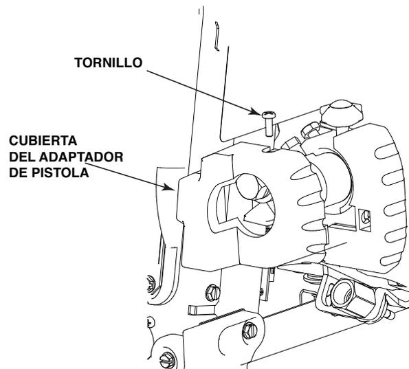
8. Seleccione el tubo guía apropiado y asegure con el tornillo de fijación.
