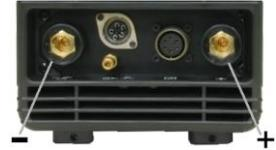
Dans le cas d'une application en courant continu et polarité négative (-), connectez le câble électrode à la borne (-) et la pince de masse à la borne (+).
