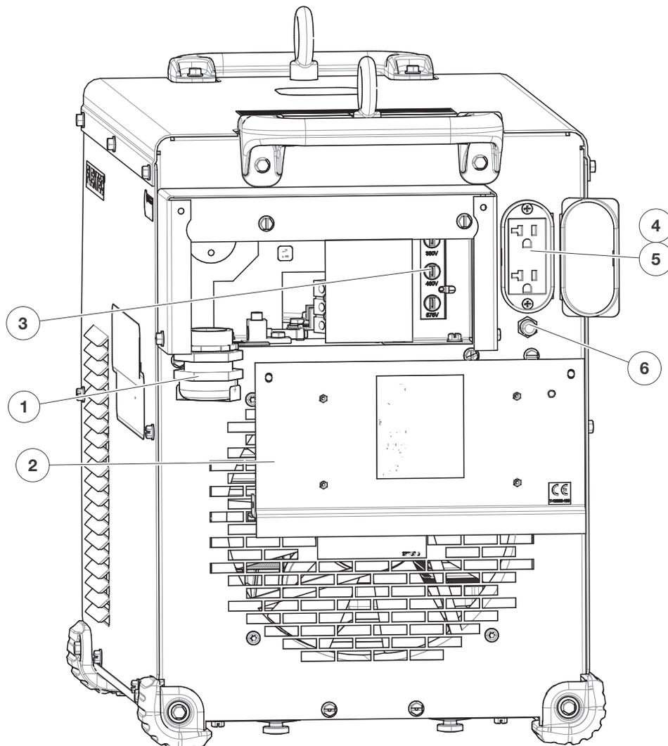
**CONTRÔLES INTERNES – HABILITATION DU VRD™, SOUDURES MULTIPLES ET CALIBRAGE DU COURANT / DE LA TENSION**
