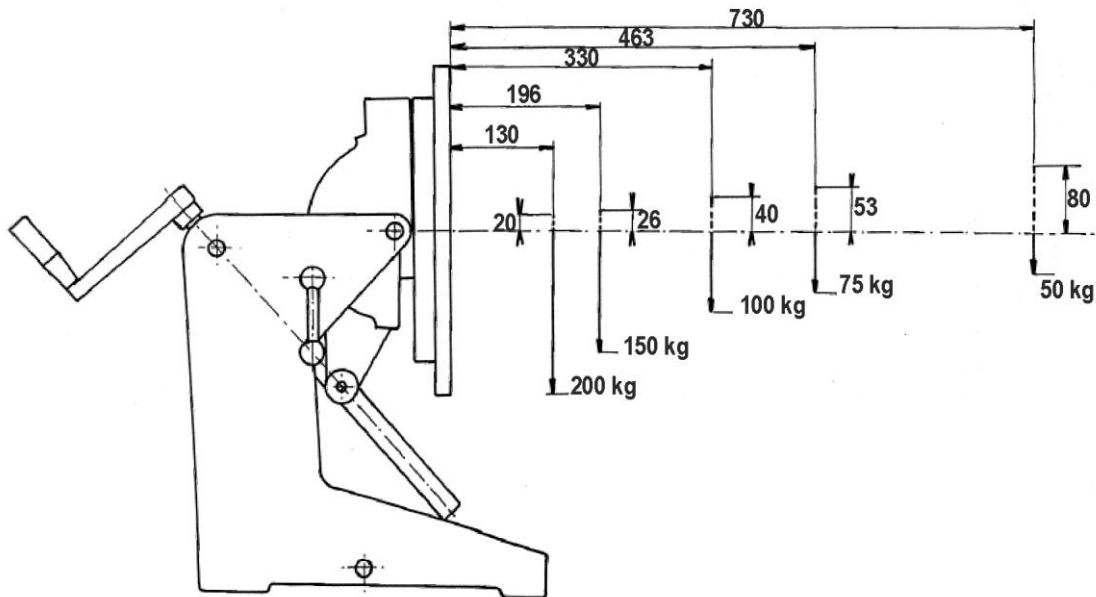
Toto zařízení umožňuje polohování dílů různých tvarů a maximálně tak ulehčuje realizaci prací, jako jsou svařování, řezání kyslíkem, potahování, pokovování atd., protože umístí pracovní linku do nejlepší pozice.
