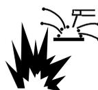
Las **CHISPAS DE SOLDADURA** pueden causar incendios o explosiones.
