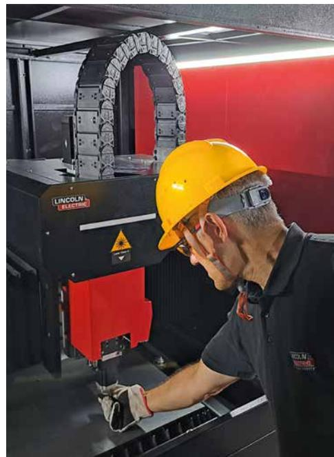
La cella completamente chiusa impedisce l'emissione della luce infrarossa del processo di taglio laser. Grazie alle porte scorrevoli, l'accesso alla testa di taglio per cambiare gli ugelli, ad esempio, è estremamente rapido e completamente sicuro, grazie al controllo della chiusura della porta tramite sensore a doppio canale.
