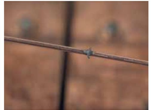
Nach dem Verschweißen und Entgraten muss der Draht über die Brücke sicher zwischen den beiden Fässern befestigt werden. Dazu die Federstifte auf beiden Seiten drücken. Bei richtiger Einstellung schwenkt der Arm von einem Fass zum nächsten.
