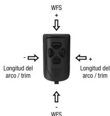
Los botones izquierdo y derecho ajustarán la longitud del arco o trim (tensión del arco) según el modo de soldadura.
