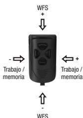
Los botones izquierdo y derecho permiten cambiar entre el conjunto de parámetros de soldadura guardados (una memoria de usuario) mientras no se suelda.
