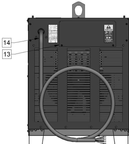
13. Задняя крышка доступа: снять для установки панели переключения на правильное напряжение питания (3x380 или 3x415 В).
