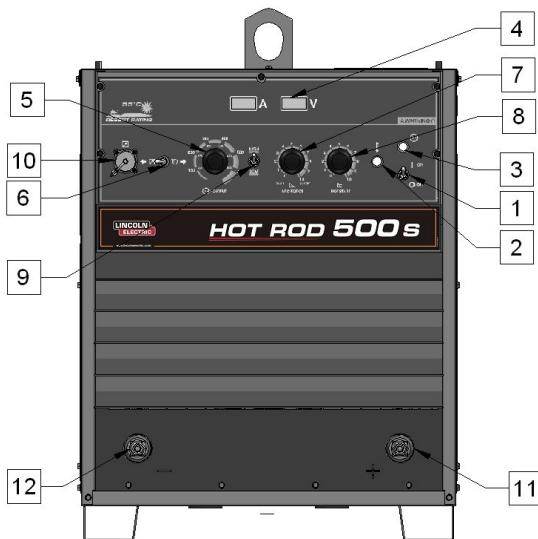
1. Выключатель питания «Вкл/Выкл»: управляет подачей питания на аппарат.
