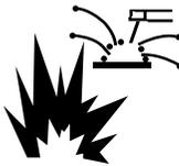
Las **CHISPAS DE SOLDADURA** pueden provocar incendios o explosiones.
