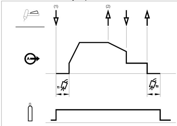
Como muestra la siguiente gráfica, si se pulsa y mantiene apretado el gatillo de la antorcha TIG por segunda vez durante la pendiente descendente, finalizará la pendiente y la corriente de salida se mantendrá con el valor de la corriente de cráter. Si se suelta el gatillo, la salida se apagará y comenzará el tiempo del postfluido de gas. Esta secuencia de funcionamiento de 2 pasos con reinicio desactivado es el ajuste predefinido en fábrica.
