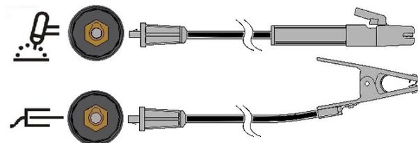
Conecte el cable del electrodo al conector de la antorcha y el cable de la pinza de masa al conector de la masa. Inserte el enchufe con la guía alineada con la ranura y gire aproximadamente  $\frac{1}{4}$  de vuelta en el sentido de las agujas del reloj. No apriete en exceso.
