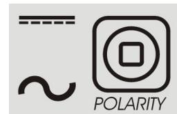
Este icono permite definir el tipo y polaridad de la corriente del proceso de soldadura empleado: CC+, electrodo revestido en CA, TIG en CC y en CA.
