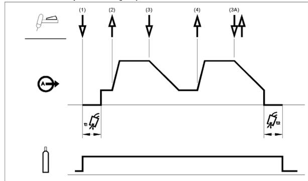
3. Pulse y mantenga presionado el gatillo de la antorcha TIG. Ahora la máquina reducirá la corriente de salida a una tasa controlada, o tiempo de la pendiente descendente, hasta alcanzar la corriente de cráter.
