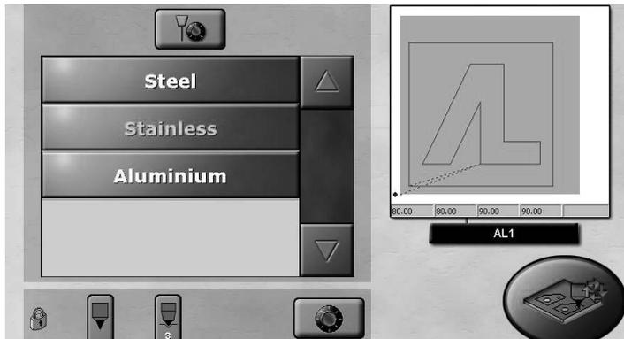
*Esta pantalla permite elegir el material a cortar con los procesos internos o seleccionar un proceso externo.*
