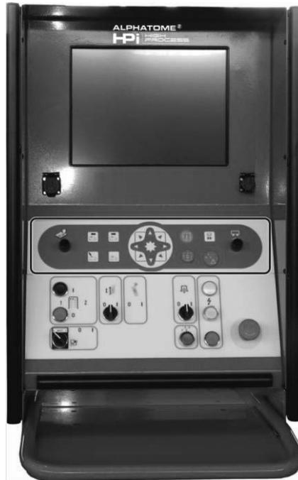
El **HPC HPI** permite gestionar automáticamente los parámetros de corte en función de la instalación y del material a recortar asociados a programas de piezas.
