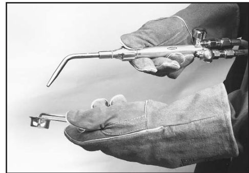
Figura 11. Encendido del Gas Combustible
