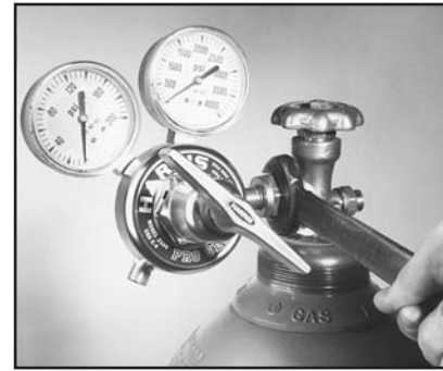
Figura 3. Acoplamiento del Regulador de Gas
