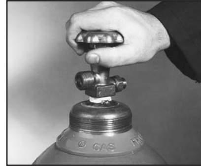
Fig.1. Abertura da Válvula do Cilindro de Oxigênio
