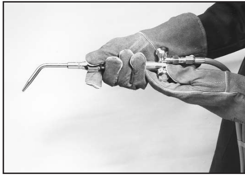
Figure 12. Réglage de la flamme
