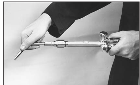
Figura 6. Instalacion de la punta la soldadura
