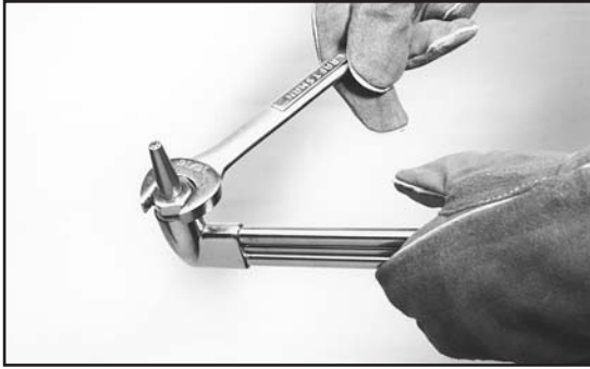
Figure 7. Montage du bec de découpe
