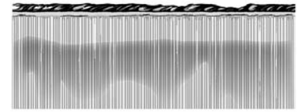
D. Préchauffage trop élevé Arêtes arrondies par suite de chauffage trop élevé. Ceci n'accélère pas la découpe et ne fait que gaspiller du gaz.
