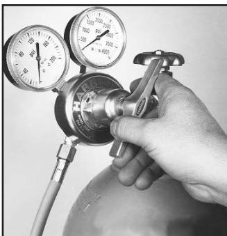
Figure 8. Clef de réglage du détendeur
