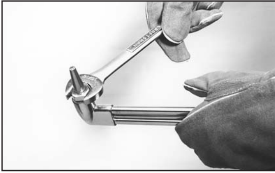
Figura 7. Instalación de la punta para el corte
