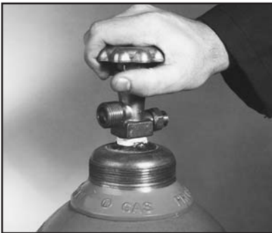
Figura 1. Abriendo la Válvula de Oxígeno en et Cilindro
