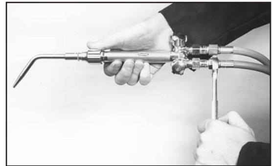
Figura 5. Acoplamiento de las Mangueras al Soplete
