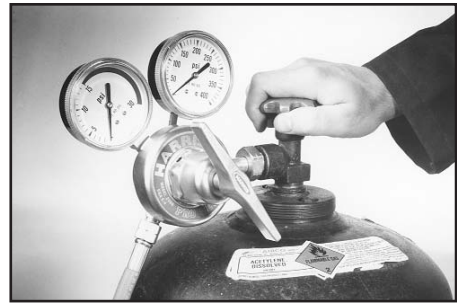
Figure 9. Ouverture du pointeau du cylindre de gaz combustible
