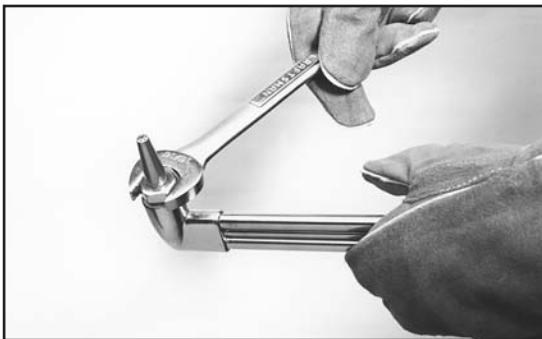
Figura 7 – Instalação da ponta de corte
