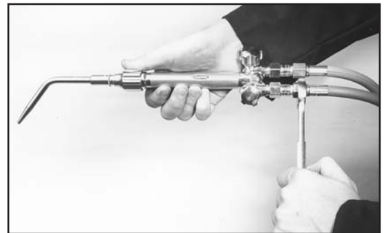
Figure 5. Raccordement des tuyaux au chalumeau
