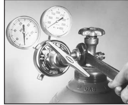
Figure 3. Raccordement du mano-détendeur pour gaz combustible
