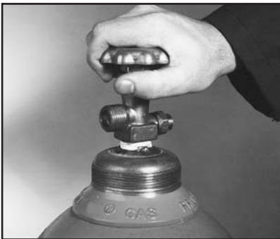
Figure 1. Ouverture du pointeau du cylindre d'oxygène
