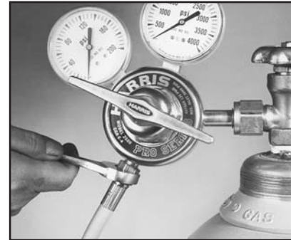
Figure 4. Fixation du tuyau au détendeur
