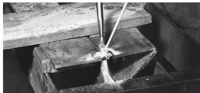
Figura 18. Solda em Latão
