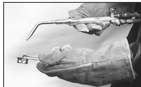
Figure 11. Allumage du gaz combustible
