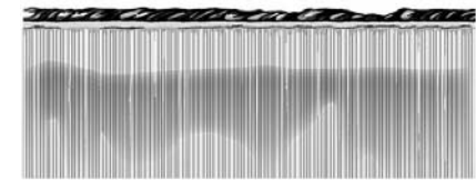
D. Pré-aquecimento excessivo causa bordas arredondadas pelo excesso de calor. O excesso de pré-aquecimento não aumenta a velocidade de corte. Apenas desperdiça gás.
