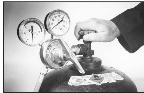
Fig. 9 Abertura da Válvula do Cilindro de Gás Combustível
