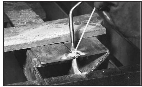
Figure 18. La Soldadura con Laton
