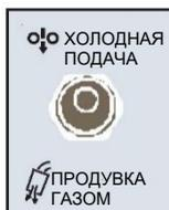
Для включения холодной подачи питания удерживайте переключатель в положении **ВПЕРЕД**. Привод подачи проволоки подает проволоку на электрод, но ни источник питания, ни газовый электромагнитный клапан не будут запитаны. Отрегулируйте скорость холодной подачи, повернув ручку WFS. Холодная подача или «холодное толчковое перемещение» электрода может быть полезной при протягивании электрода через горелку.
