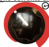
Viene utilizzata per regolare la corrente in uscita impiegata per la saldatura.
