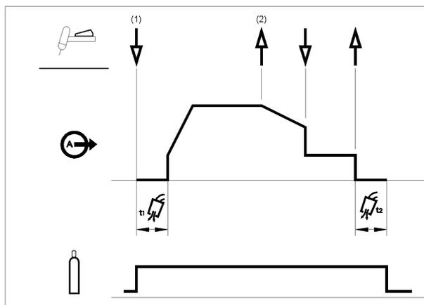
Come illustrato sopra, è possibile tenere premuto l'attivatore della torcia TIG una seconda volta durante la discesa per terminare la funzione di discesa e mantenere la corrente in uscita al valore della corrente di Cratere. Quando si rilascia l'attivatore della torcia TIG, l'uscita si spegne e inizia il tempo di post flow. Questa sequenza del funzionamento, 2-tempi con ripartenza attivata, è l'impostazione predefinita in fabbrica.
