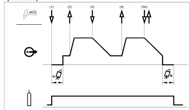
3. Tenere premuto l'attivatore della torcia TIG. Ora la macchina riduce la corrente in uscita a una frequenza controllata, o a un tempo di discesa, fino a raggiungere la corrente di Cratere.
