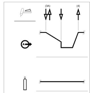
Come illustrato qui, dopo una pressione e un rilascio rapidi dell'attivatore della torcia TIG dalla fase 3A, è possibile premere e rilasciare rapidamente l'attivatore della torcia TIG una seconda volta per terminare il tempo di discesa e arrestare la saldatura.
