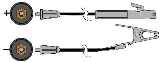
Collegare al terminale (+) il cavo all'elettrodo e al terminale (-) il cavo al giunto da saldare. Inserite il connettore allineando la chiavetta con la scanalatura e stringete ruotando di circa ¼ di giro in senso orario. Non stringete troppo.
