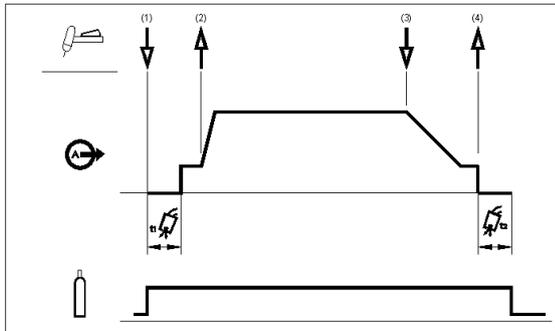
1. Tenere premuto l'attivatore della torcia TIG per innescare la sequenza. La macchina apre la valvola del gas per avviare il flusso del gas di protezione. Dopo il tempo di pre flow, spurgare l'aria dal tubo della torcia, l'uscita della macchina è accesa. A questo punto l'arco viene avviato secondo la modalità di saldatura avviata. Una volta avviato l'arco, la corrente in uscita sarà al valore della corrente di avvio. È possibile mantenere questa condizione per l'intervallo di tempo necessario.
