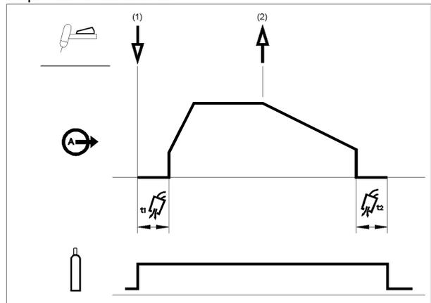
1. Tenere premuto l'attivatore della torcia TIG per innescare la sequenza. La macchina apre la valvola del gas per avviare il flusso del gas di protezione. Dopo il tempo di pre flow, spurgare l'aria dal tubo della torcia, l'uscita della macchina è accesa. A questo punto l'arco viene avviato secondo la modalità di saldatura avviata. Una volta avviato l'arco, la corrente di uscita aumenta a una frequenza controllata, o con il tempo di salita, fino a raggiungere la corrente di saldatura.
