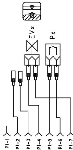
**Примечание:** в этом случае установите расходомер справа и измените подключение проводки как показано на схеме
