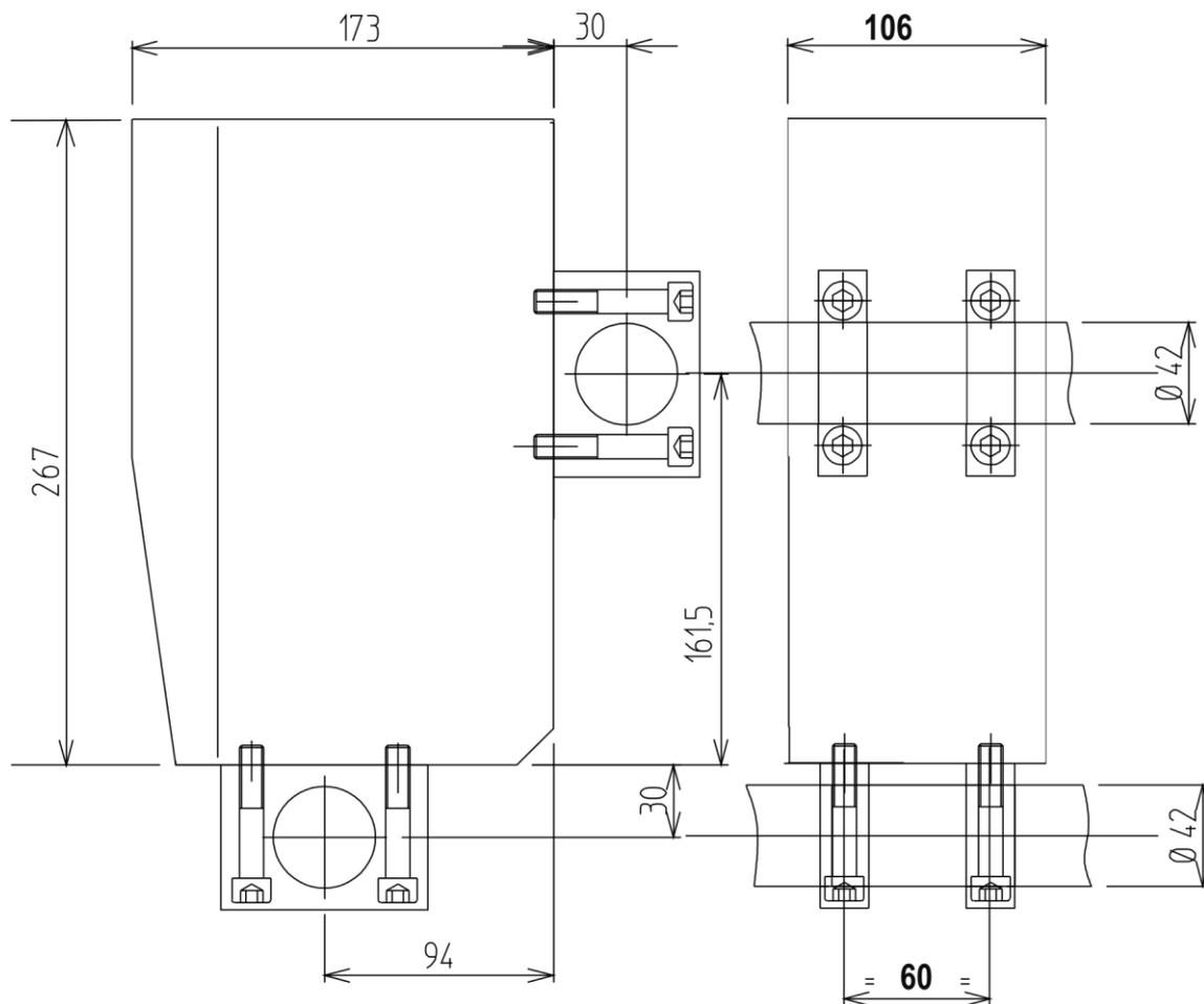
Установите опорные кольца на передней или нижней части блока (используйте ту же сторону, что и для панели управления).
