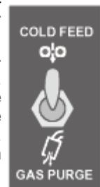
Maintenir le commutateur sur la position du BAS pour activer l'Échappement du Gaz et laisser le gaz de protection s'écouler. La valve du solénoïde de gaz se trouvera sous énergie mais ni la sortie de la source de puissance ni le moteur d'entraînement seront allumés. L'interrupteur d'Échappement du Gaz est utile pour régler le débit approprié du gaz de protection. Il faut toujours ajuster les débitmètres lorsque le gaz de protection s'écoule.
